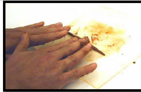
Confectionner le rouleau de sol manuellement sur une marbre
