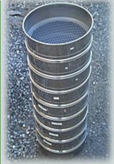
Colonne de tamis d'ouvertures différentes
